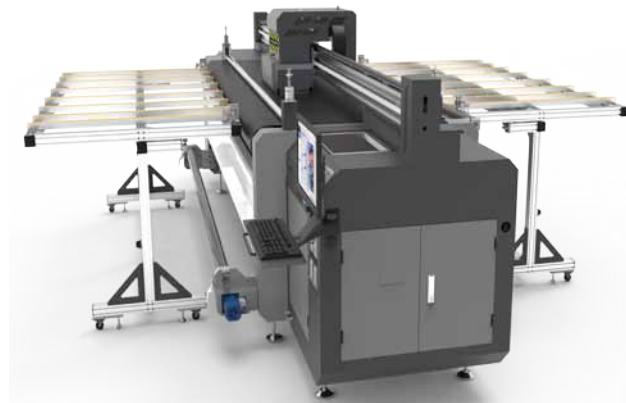
A RH3208 pode vir opcionalmente equipada com a nova tecnologia de motor linear magnético para o carro de impressão, que dispensa o uso de correia e proporciona uma operação mais silenciosa e precisa.
